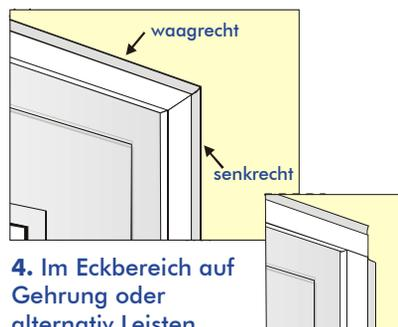
4. Im Eckbereich auf Gehrung oder alternativ Leisten hinterschnitten stoßen.
